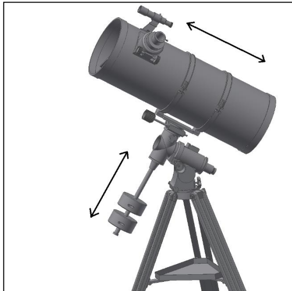
Abb. 14. Das Teleskop ausbalancieren.
