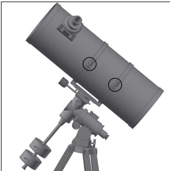
Abb. 9. Anbringung des Tubus und der Rohrschellen.
