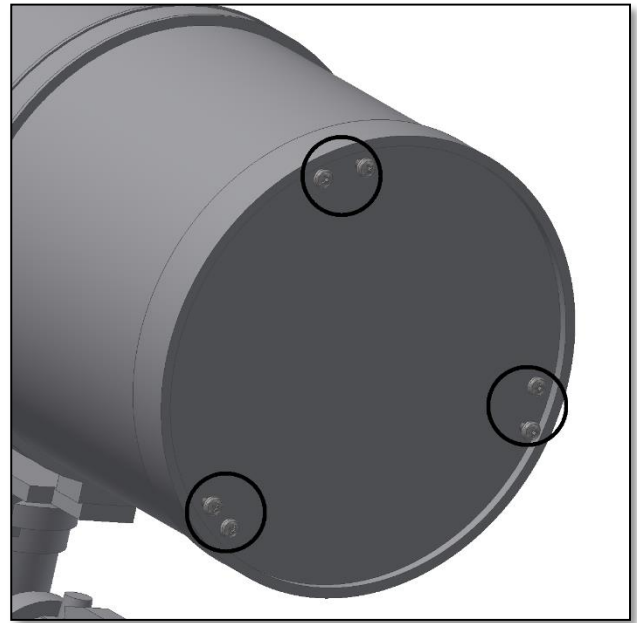
Abb. 18. Den Hauptspiegel justieren.
