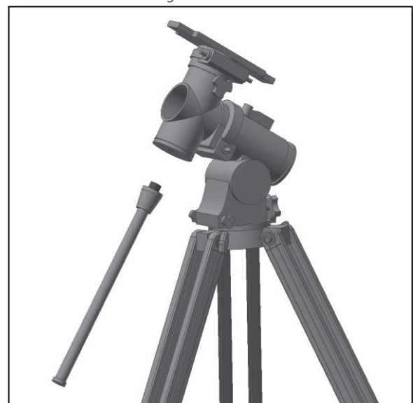
Abb. 5. Anbringung der Gegengewichtsstange.
