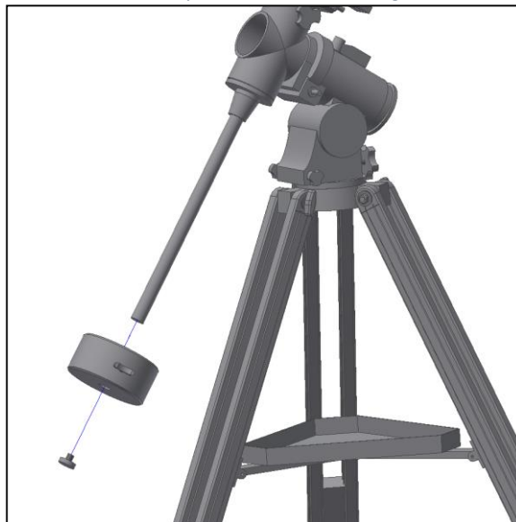
Abb. 6. Anbringung des Gegengewichts und der Abschlusschraube.
