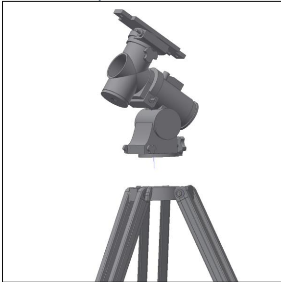
Abb. 4. Einbau der Äquatorialen Mountierung.
