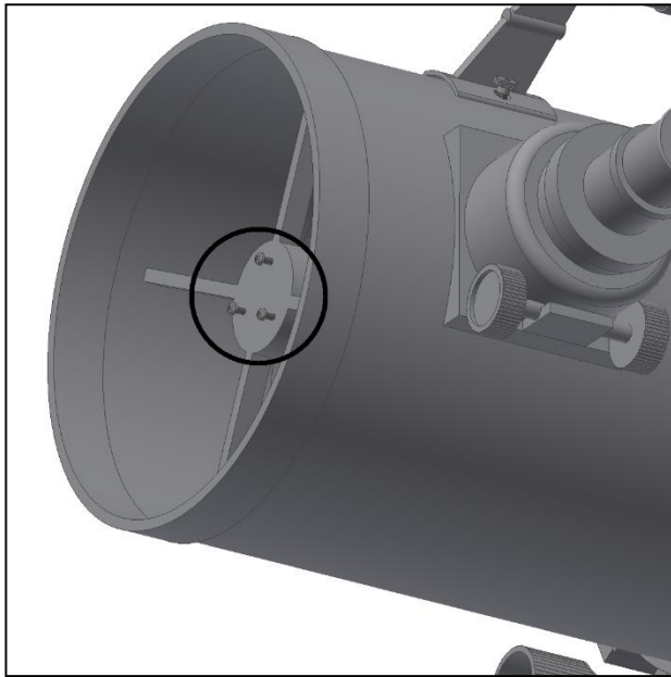
Abb. 17. Den Fangspiegel justieren.
